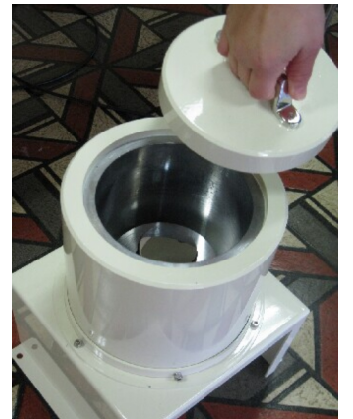
五日市庁舎に設置された食品放射線測定器。鉛製のふたはとても重い。
